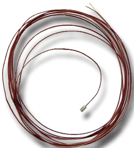
La temperatura della cavità 3 mm TS-PF03-K press-fit analizza la variazione di temperatura all'interno della cavità dello stampo. Il TS-PF03-K è stato progettato per venire utilizzato insieme al sensore termocoppia Lynx Quad Temp - TIPO K (LS-QTTB-K) di RJG Inc., che può essere collegato con fino a quattro termocoppie, e al sistema eDART®.
