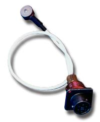
I sensori estensimetrici analogici a canale singolo Lynx™ T-414-12, T-412-12 e T-413-12 sono sensori di pressione in cavità indiretti (sotto il perno), da 0,50" (12,7 mm), con uno stelo brasato sul corpo e un connettore antistrappo.
