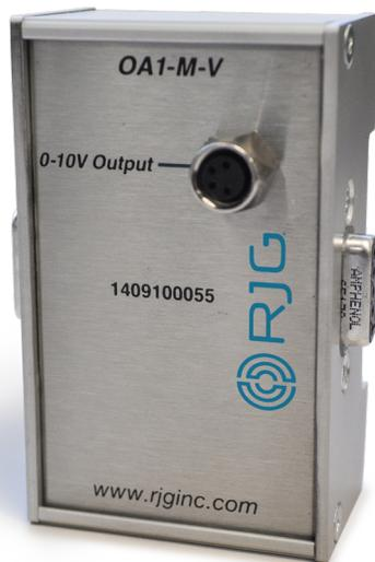
Il modulo di uscita analogico schermato Lynx™ OA1-M-V è un modulo montato su guida DIN che è collegato alla macchina di formatura per emettere un segnale da 0–10 V DC che rappresenta i parametri di stampaggio o come trasferimento macchina esterno. L'uso di un modulo ID7-M-SEQ (o DIN/LX-D) è necessario per collegare fisicamente l'OA1-M-V al sistema eDART® o CoPilot®. il suo modulo guida DIN è schermato per garantire dati di alta qualità anche in ambienti di stampaggio robusti.
