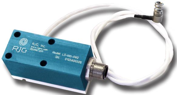
Il sensore di deflessione dello stampo Lynx LS-MD-040 misura fino a 0,040" (1.016 mm) di deflessione dello stampo sulla linea di separazione ogni ciclo per l'uso con il sistema eDART® o CoPilot®.
