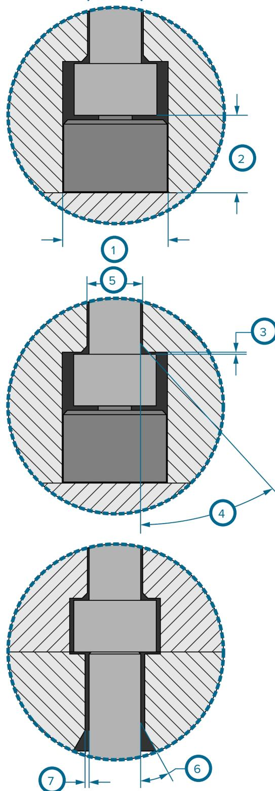
**NOTA** Ci deve essere  $0.50''$  (12,0 mm) MIN morsetto spessore della piastra sopra la testa del perno trasferimento al pin trasferimento uscita clearanced, eguagliando  $1/3$  del perno lunghezza ; Se  $1/3$  perno lunghezza non è possibile in morsetto spessore della lamiera, uso head-to-head concetto a pagina 10.
