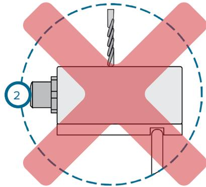
4. Orientamento del connettore Lynx in caso Lynx è alterata da OEM (3 A destra).
