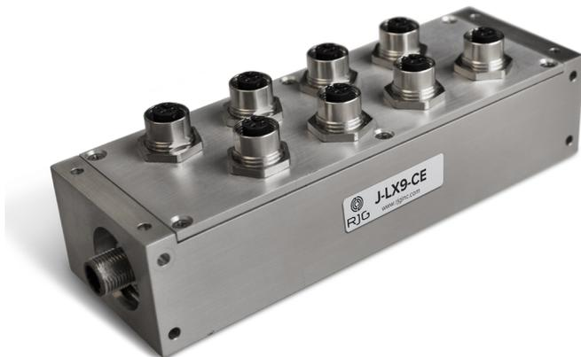
La giunzione a nove porte Lynx™ J-LX9-CE fornisce connessione e alimentazione per un massimo di nove dispositivi Lynx ai sistemi eDART® o CoPilot tramite un'unica connessione e può essere montata su macchina o su stampo, anche su piastre mobili o fisse o metà dello stampo.
