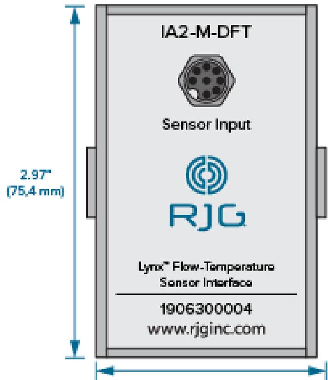
Il modulo di interfaccia digitale della temperatura di mandata Lynx™ IA2 - M - DFT fornisce tutti gli ingressi e le uscite necessari per interfacciare il sistema eDART® o CoPilot® con TracerVM™ di Smartflow® o TracerVM di Smartflow con la linea di misuratori di portata dell'interfaccia utente. IA2-M-DFT è schermato per garantire dati di alta qualità anche in ambienti di stampaggio difficili ed è progettato per l'uso con altri moduli di interfaccia schermati Lynx.
