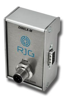
L'adattatore di comunicazione schermato Lynx™ DIN/LX-M è un modulo di comunicazione da Lynx a guida DIN che interfaccia altri RJG, Inc. Moduli Lynx schermati montati su guida DIN ai sistemi eDART® o CoPilot® quando non viene utilizzato un modulo di sequenza schermato Lynx ID7-D-SEQ. il suo modulo guida DIN è schermato per garantire dati di alta qualità anche in ambienti di stampaggio robusti.
