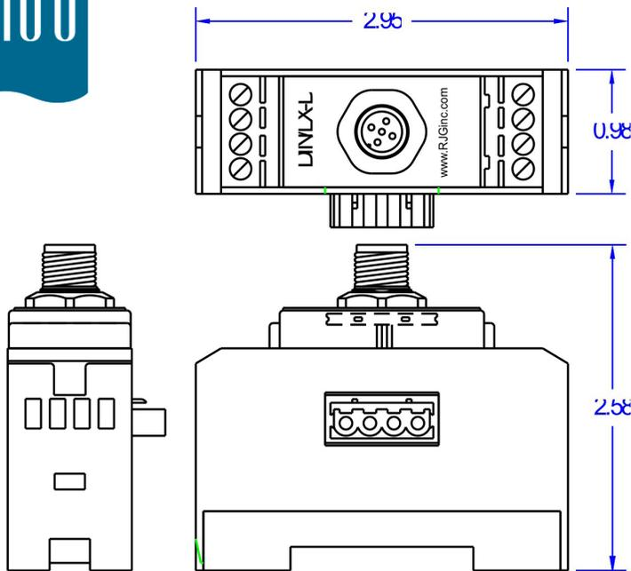
Il DIN/LX-D è un modulo di comunicazione Lynx su binario DIN che opera come interfaccia tra i cavi standard Lynx e i moduli Lynx montati su binari DIN quando non si usa un ID7-D-SEQ. Il DIN/LX-D è progettato per l'uso con il Sistema eDART®.
