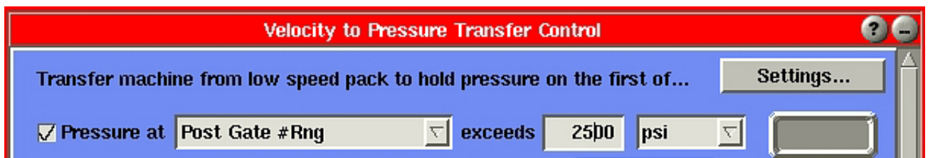
Figura 15: Inserire un Valore Impostato di Commutazione sul Post Gate #Rng (Schermata Commutazione V - P)
