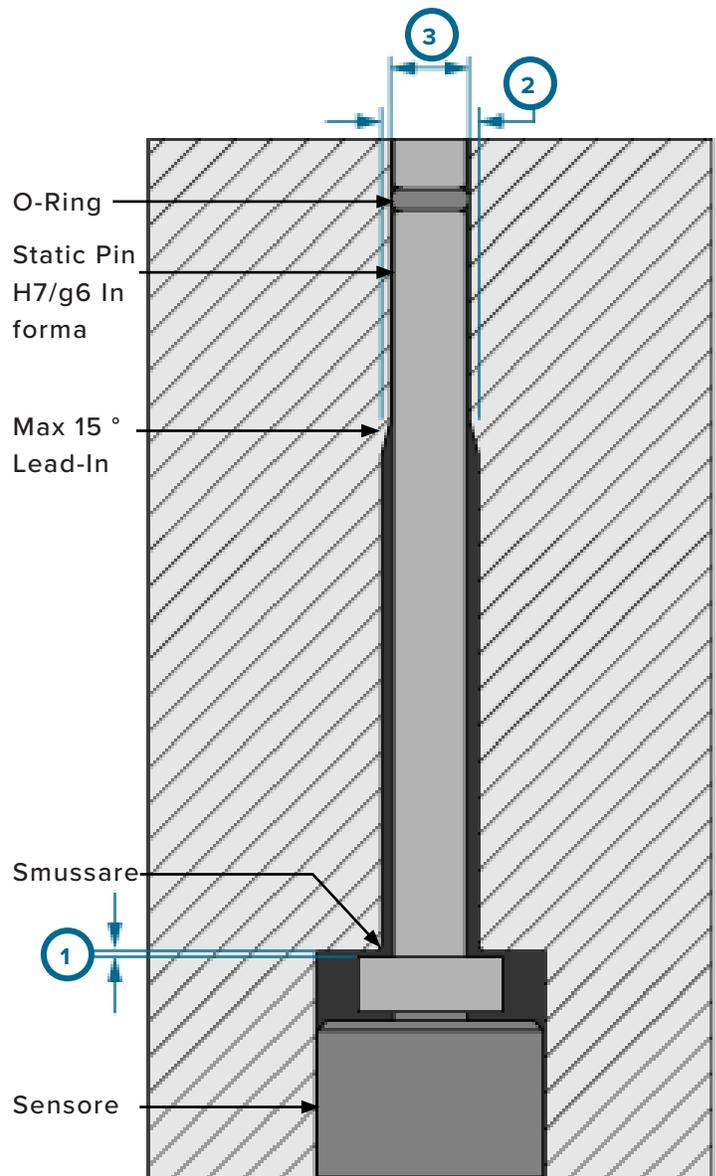
**AVVISO** Queste linee guida sono per perni 3/32" (2,5 mm) diametro uguale o maggiore. Si prega di contattare l'assistenza clienti RJG per l'installazione di perni statici più piccolo 3/32" (2,5 mm) di diametro
