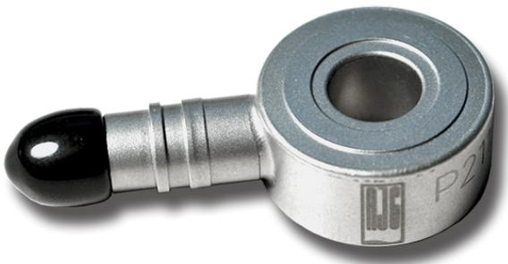
Il sensore piezoelettrico della rondella di carico 211M18 misura la cavità pressione sui manicotti di espulsione. Per i manicotti degli eiettori, il pin centrale si estende attraverso la rondella di carico in modo tale che venga monitorata solo la pressione del manicotto dell'eiettore.
