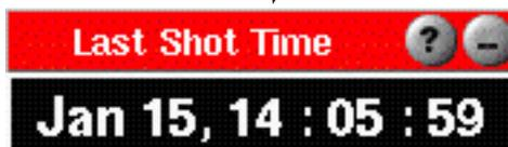
L'ora sullo strumento coincide con i campi temporali sugli strumenti Grafico Ciclo e Grafico Sommario. L'ora sul Visualizzatore Tempo Stampata si aggiorna ad ogni ciclo.
